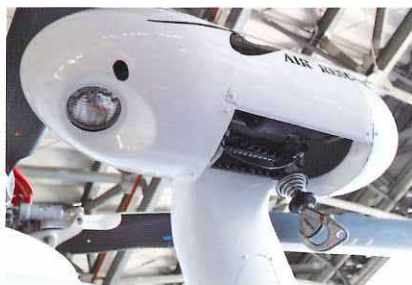
ホイスト装置 吊上げ能力 272kg/90m
