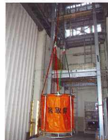
消火バケツ 容量 1,000 リットル
