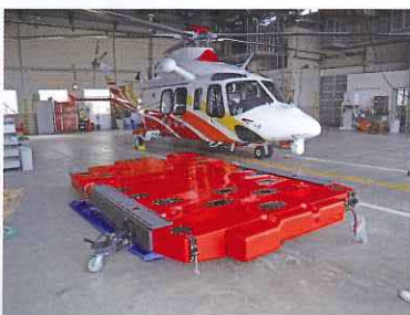
消火タンク (ファイヤーアタッカー) 容量 1,800 リットル
