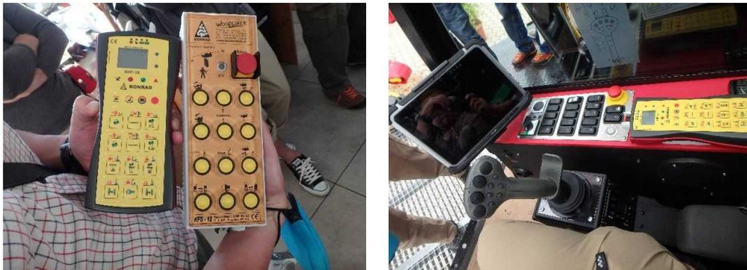
写真一25 架線搬器のリモコン（左）、ハーベスタ操縦席（リモコンがある）（右）
