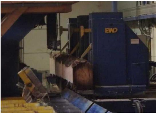
写真一41 PREIN 社の高性能帯鋸製材機
