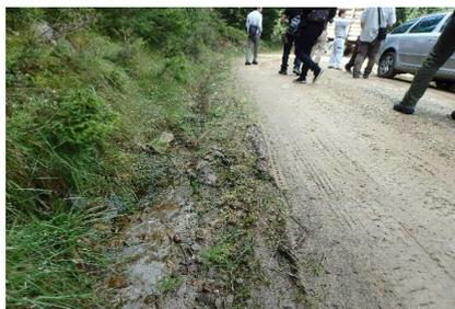
写真-7 山側の素掘り側溝
