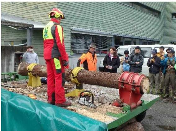
写真一32 風倒木を想定した伐採練習装置
