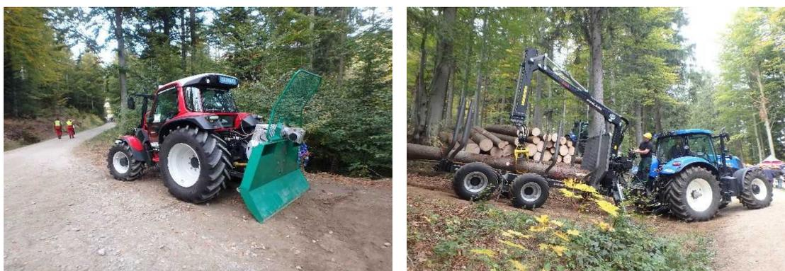
写真一3 ウインチ付トラクタ (左) と牽引型フォワーダを取り付けたトラクタ (右)
