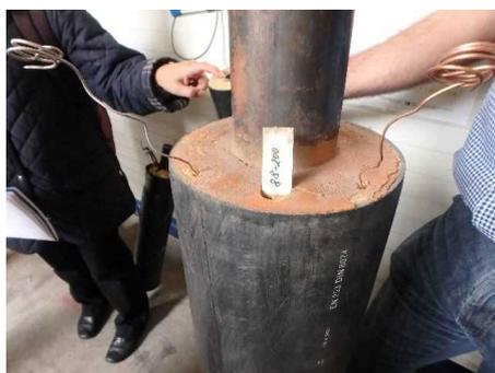
写真—68 漏水確認用の電極センサー
