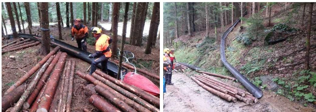
写真—16 ログライン上部のソリ（左）とログライン下端の状況（右）
