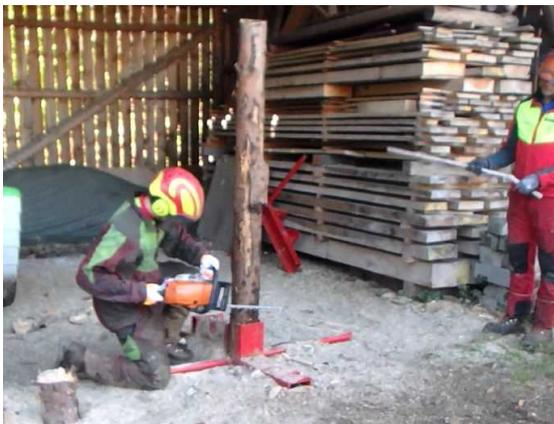
写真一30 伐倒練習用丸太固定装置
