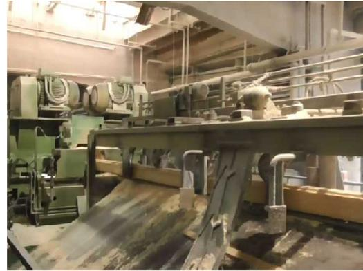
写真—54 プロファイリング製材ライン
