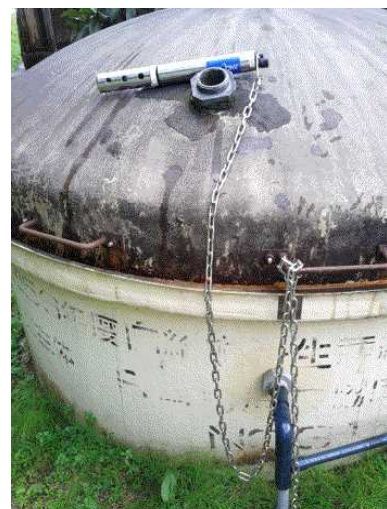
写真2 多項目水質計と曝気槽
