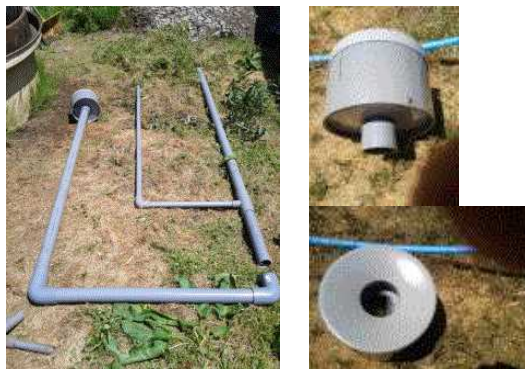
写真8 スカムスキマーの配管とフロート部
