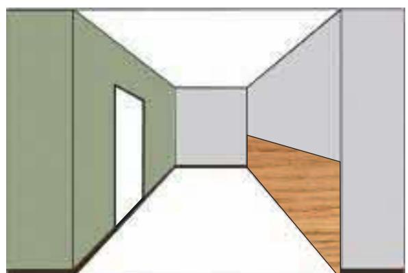
良い事例5は、床面は明度の低い灰色とし、壁面は明度の高い白色を配色しています。床面と壁面において色のコントラスト(色の明度差)が確保できなかった場合、壁面の巾木(相互に近接する部分)において、明度の低い茶色を配色し、色のコントラストを確保した事例です。
