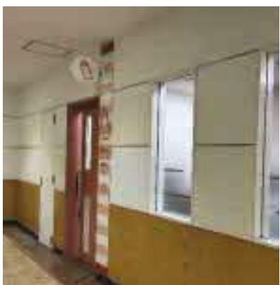
床面は明度の低い茶色とし、壁面は明度の高い白色を配色しています。また、廊下の腰壁に明度の高い木目調、廊下の床面(近接部分)に、明度の低い茶色を配色し、色のコントラストを確保しています。
