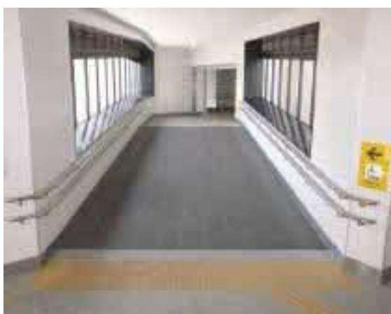
壁面は明度の高い白色とし、傾斜部分は明度の低い灰色と色のコントラストを設けています。また、前後の廊下等とは床面の色の明度を変更し、弱視者にもわかりやすいように配慮しています。色相による色のコントラストを確保した標識や点状ブロック等を設置しています。
