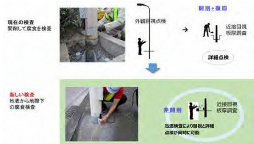
鋼板腐食検査器を使用した調査
