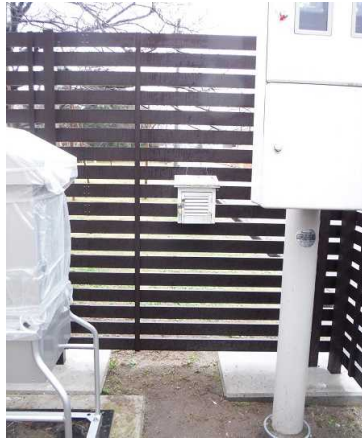
図 5 積算線量計の設置状況（移設 2 回目、令和元年 11 月）
