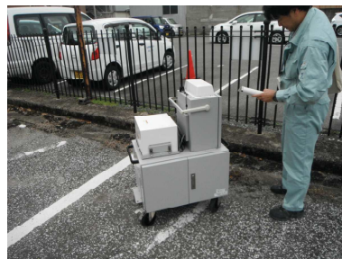
可搬型モニタリングポストによる測定
