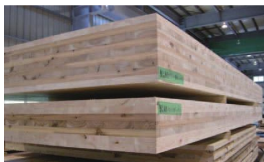
図1 CLT(上は9層、下は7層の製品)
