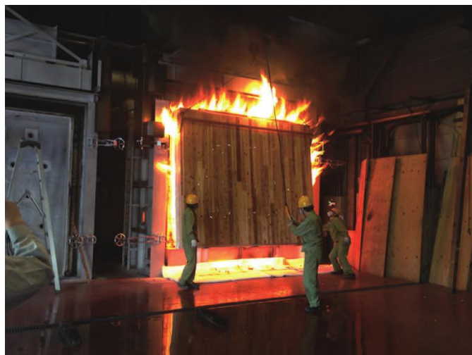
写真4 木材がゆっくり燃えるは長所（CLTの加熱実験の様子）
