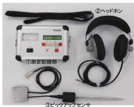
写真1 地下流水音探査装置
