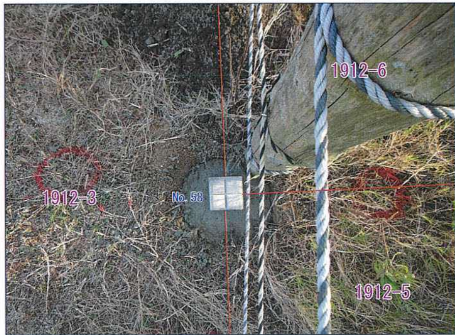
No. 58 標識: コンクリート杭
