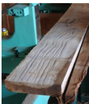
図 2 材面に生じた 筋状の落ち込み
