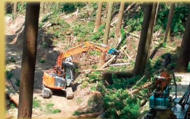
伐倒された木をワインチやグラップルで引き寄せて集め、プロセッサが造材します。
