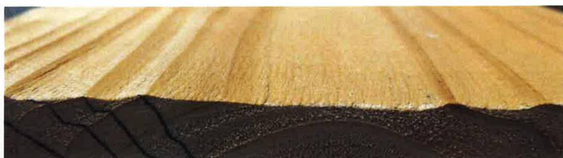
図2 選択的表層圧密「うづくり圧密(仮称)」材の表面性状
