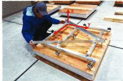
図2 反りの計測状況
