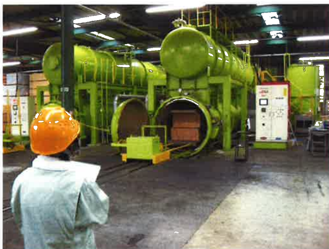
図1 CLTの薬剤注入処理（県外民間企業工場）
