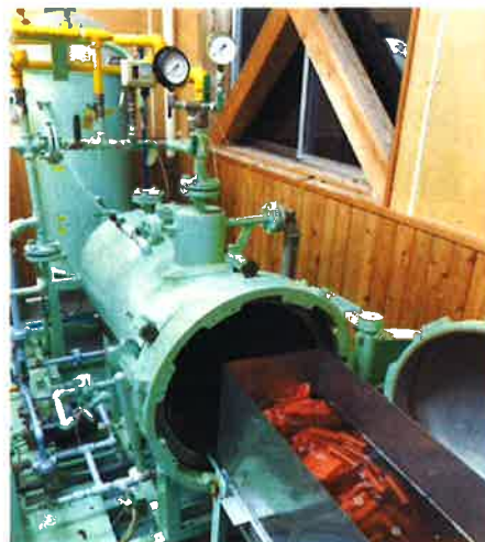
図2 剝離試験（減圧加圧試験）
