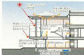
居住域空調と自然エネルギーの活用
