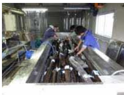
埋蔵文化財センター秋里分室 PEG含浸施設
