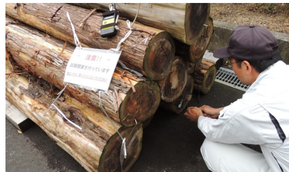
写真3 丸太のSPT計測
