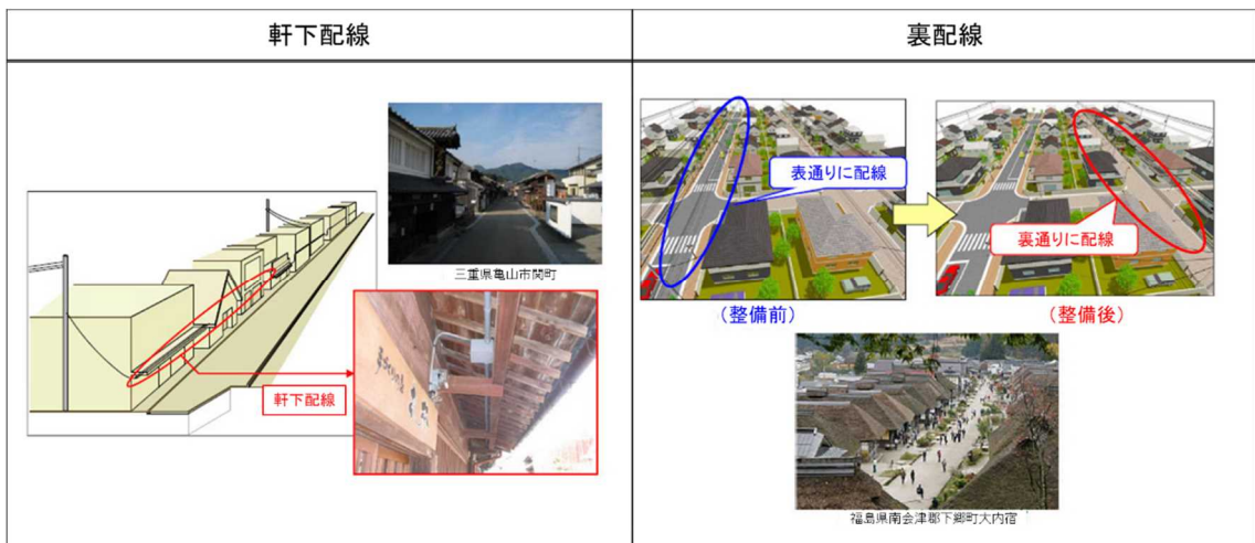
図4 軒下配線方式・裏配線方式（出典：国土交通省ホームページ）
