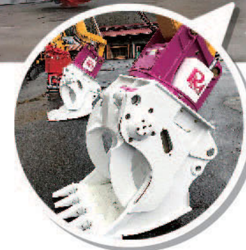
伐採と掘削兼用マシン 作業道づくりに使用
