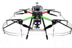
マルチコプターによる近接撮影と異常箇所の2次元計測
