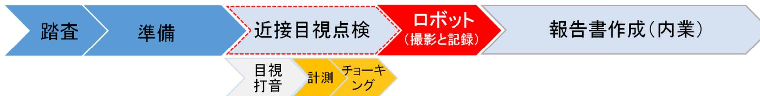
点検員による近接目視点検では、点検員が手の届く範囲に近づき、目視確認、打音までは行うが、写真撮影の省略、及びロボットで十分計測可能な変状については、人による計測とチョーキングも省略することで効率化が実現する。
