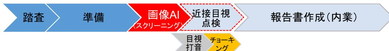
画像AIによるスクリーニング後の近接目視点検では、点検範囲の絞り込みが行ったうえで、点検員が手の届く範囲に近づき、目視確認、打音までは行うが、写真撮影とチョーキング(軽微な変状を除き)を省略することで、大幅な効率化が実現する。
