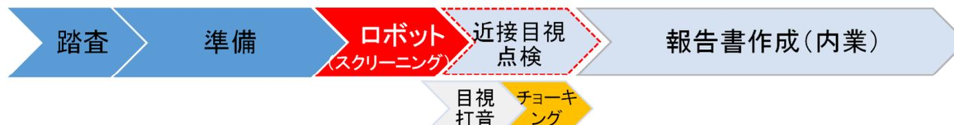
ロボットによるスクリーニング後の近接目視点検では、点検範囲の絞り込みが行ったうえで、点検員が手の届く範囲に近づき、目視確認、打音までは行うが、写真撮影とチョーキング(軽微な変状を除き)を省略することで、大幅な効率化が実現する。
