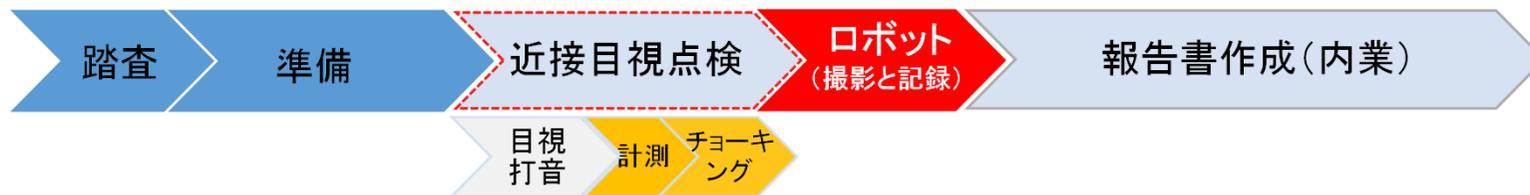
点検員による近接目視点検では、点検員が手の届く範囲に近づき、目視確認、打音までを行うが、写真撮影の省略、及びロボットで十分計測可能な変状については、人による計測とチョーキングも省略することで効率化が実現する。
