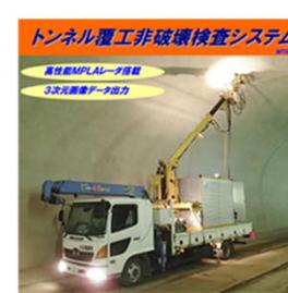
トンネル覆工非破壊検査システム
