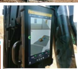
ICT建設機械に取り込まれた3次元設計データ(中の画像左)と、人工衛星を利用した測位システムによって、作業機の位置を計測。同データに合わせた半自動の施工は精度も高く、効率的
