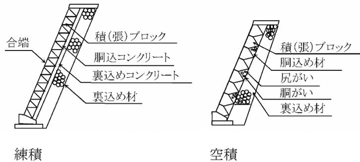
図3-2-5 コンクリートブロック工
