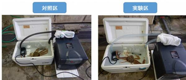
図1 脚の脱落と $\text{NH}_4^+$ 濃度の関係の検証実験の様子。 $\text{NH}_4^+$ 濃度の低下を避けるため、ろ過槽はなく、冷却機とポンプのみ接続。水槽は約50Lのクーラーボックスを使用。
