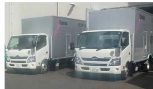
高圧発電機車
