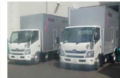
高圧発電機車
