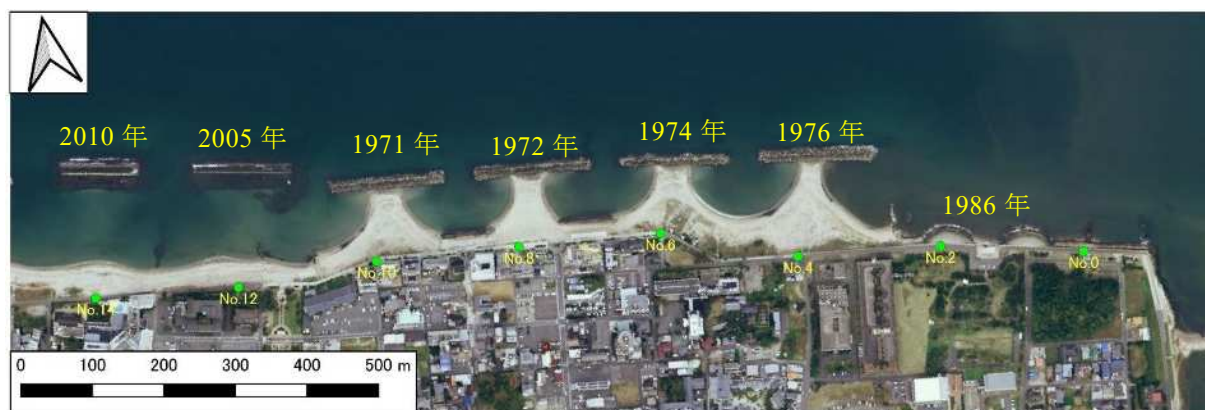
图 1.2.15(3) 皆生第1工区 施設整備履歴
