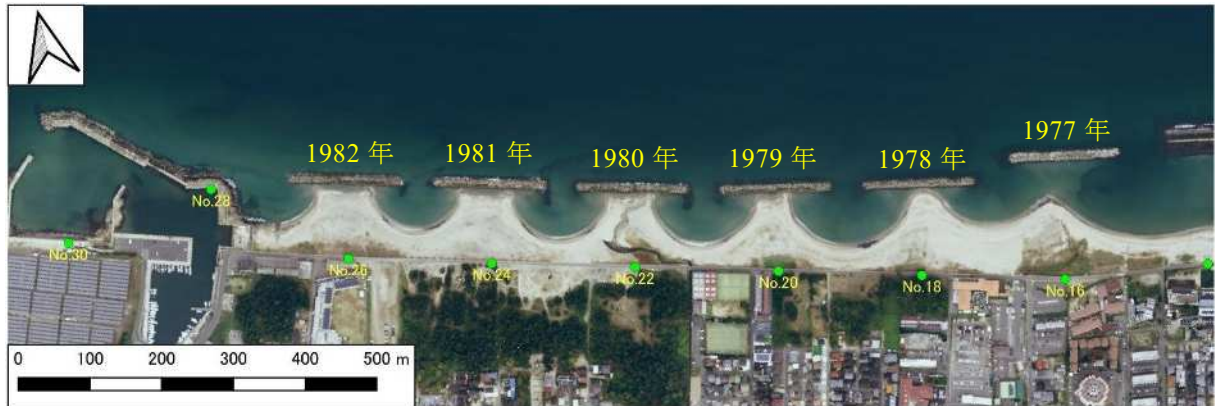
图 1.2.15(4) 皆生第 2 工区 施設整備履歴
