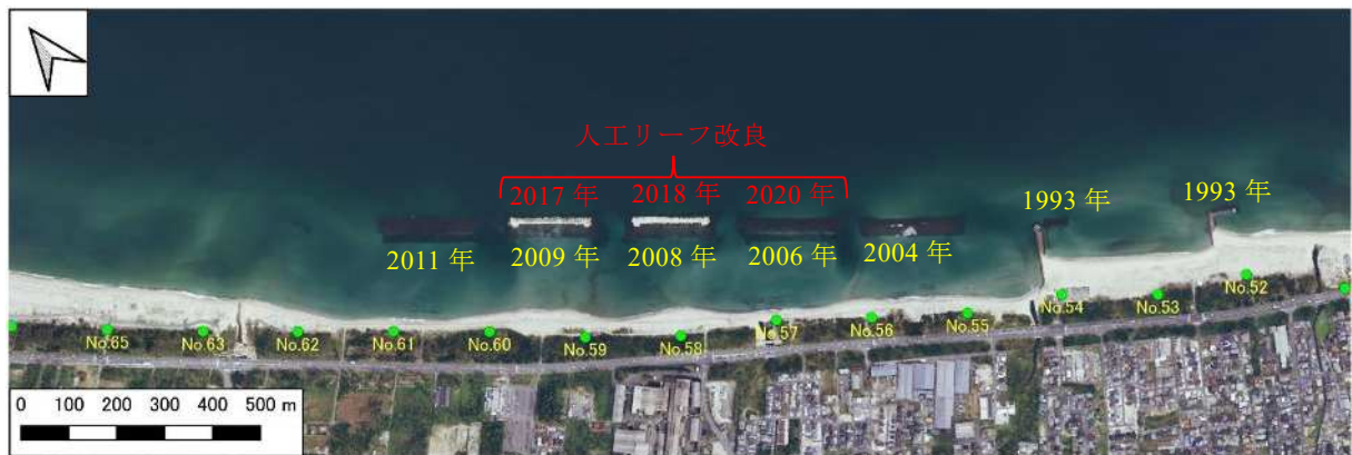
図 1.2.15(8) 夜見工区・富益工区 施設整備履歴
