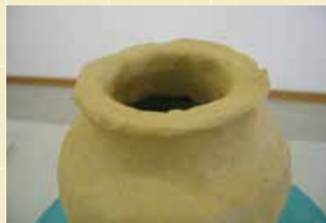
⑤口縁の部分を作り、回転台を回しながら全体がうすくなるよう外側と内側をけずります。
