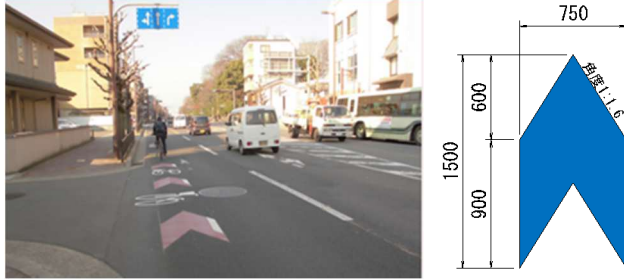
矢羽根型路面表示による自転車走行環境整備例 令和5年度から「鳥取うみなみロード」において整備中
