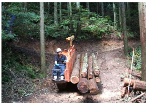
< 作業道を利用した原木搬出 >
