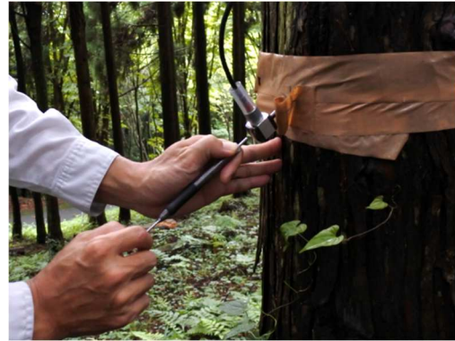
図3 定力打撃装置を使った計測状況
