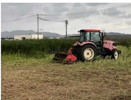
モアによる粉碎作業の様子
