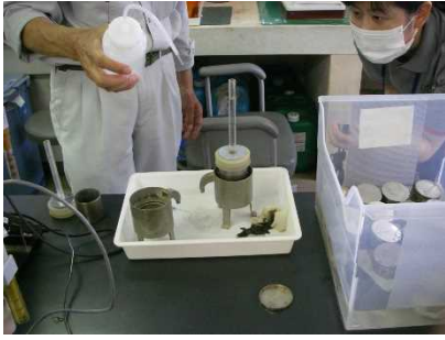
④採取した土層の透水性調査
