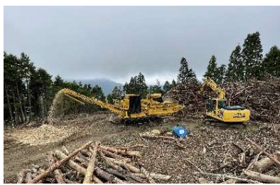
移動式チップパーでの破碎による嵩小
