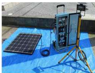
▲防災照明(ソーラーパネル+蓄電池+投光器)
