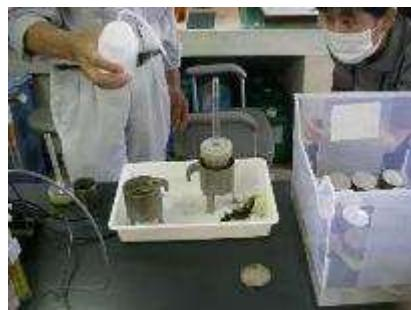
④採取した土層の透水性調査
