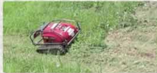
写真2:ラジコン式自走草刈機 ラジコンを用いて遠隔操作を行う草刈機。作業者は傾斜地に立つことなく、安全な場所からの操作が可能です。
