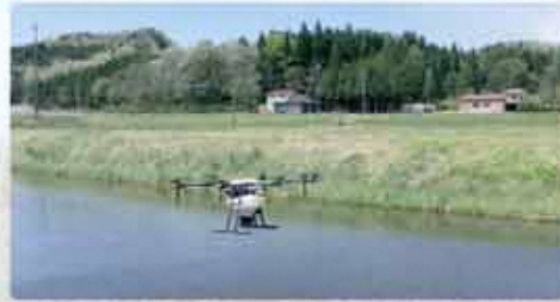
写真1:ドローンによる農業散布 搭載する散布装置を交換することで、粒剤・液剤両方の農業について空中散布が可能です。
