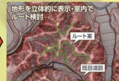
地形に応じた最適ルートをパソコンが自動検討するため、経験が少ない者でもルート計画が可能
