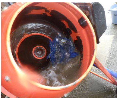
図1 付着物除去試験に用いた電動ミキサー
