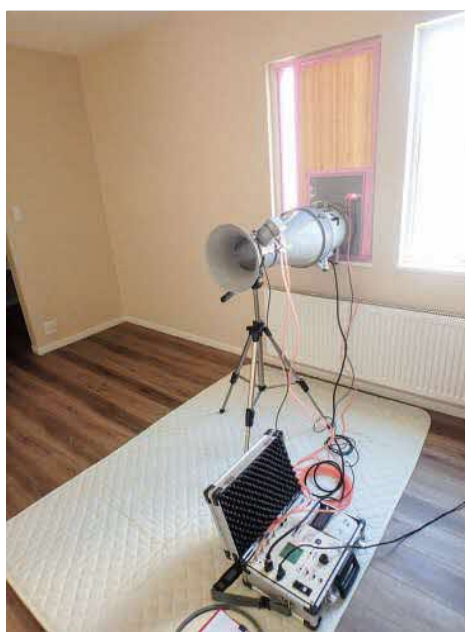
写真 4-16 気密性能試験装置の設置例
