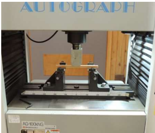
写真3 曲げ強度試験の状況
