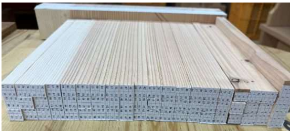
写真1 曲げ試験用試験体と見本(奥)
