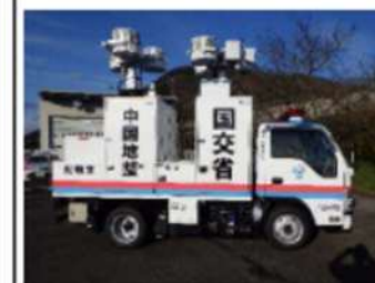
車両① 1.3kw 6灯 伸縮ポール式
