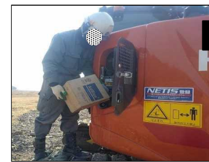
高品位尿素水補給状況
