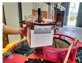
図2 長期停止の原因となった電源ボックス(この中にある基盤5枚のうちいくつかのコンデンサが過電圧と経年劣化で故障)
