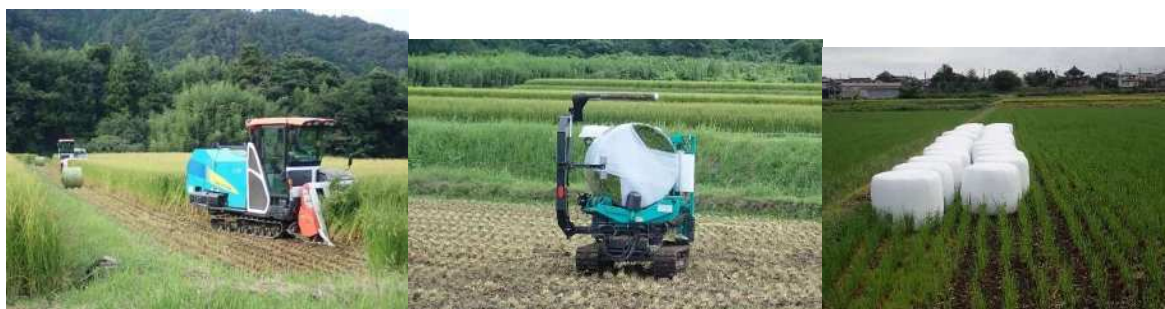
写真 飼料用稲の収穫：刈り取り細断してロールを作る収穫機とロールを包装するラップマシンの2台1組で作業する
