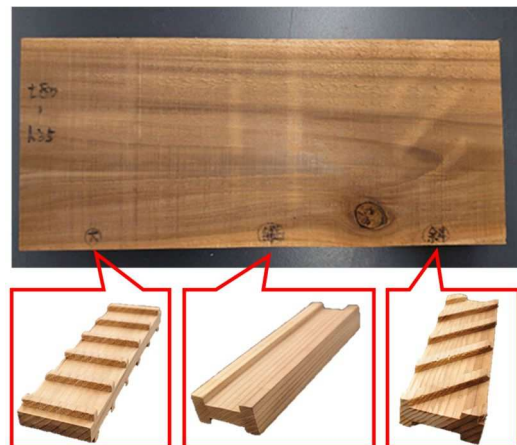
写真2 栈木形状の違いによる栈木痕の発生状況
