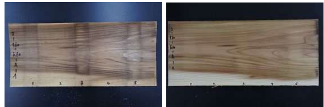
写真1 60°C60%RH(アルミの栈木)で乾燥後の試験体 左: プレーナー加工前、右: プレーナー加工後
