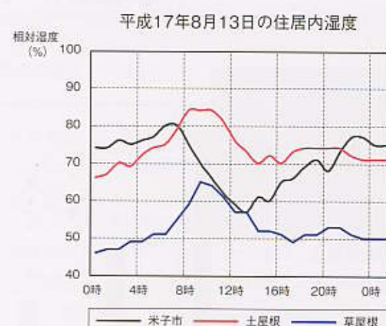
第2図 竪穴住居内の温度変化と湿度変化
