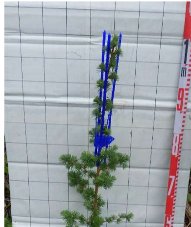
図2 使用したクリップ(左)、クリップを主軸に装着している様子(右) 成長に合わせて月1回程度クリップを付け直した
