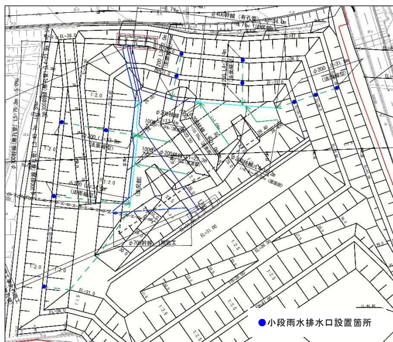
図02-8 小段雨水排水口設置箇所（第Ⅱ期）
