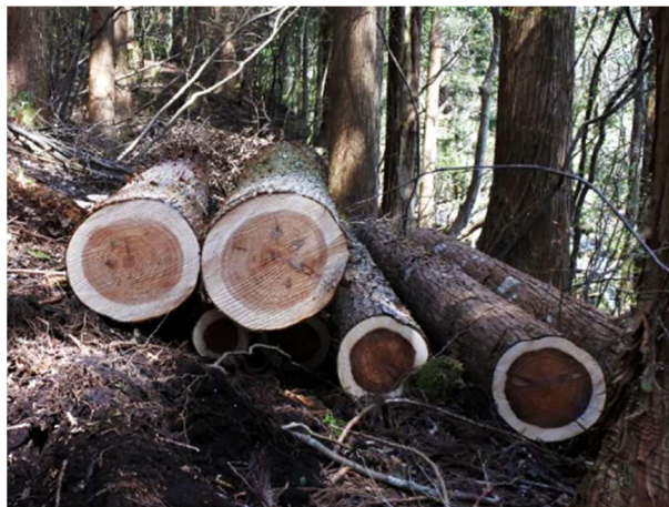
写真4 葉枯らし後の丸太(左上2本)と伐採直後の丸太の木口の変色の違い
