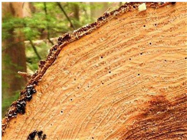
写真3 穿孔性害虫による虫害
