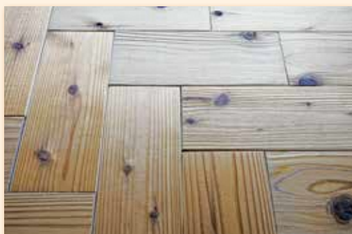
▲有節スギ板材の圧密加工技術の開発(特許取得)
