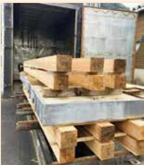
▲柱角等の反りを軽減する人工乾燥試験
