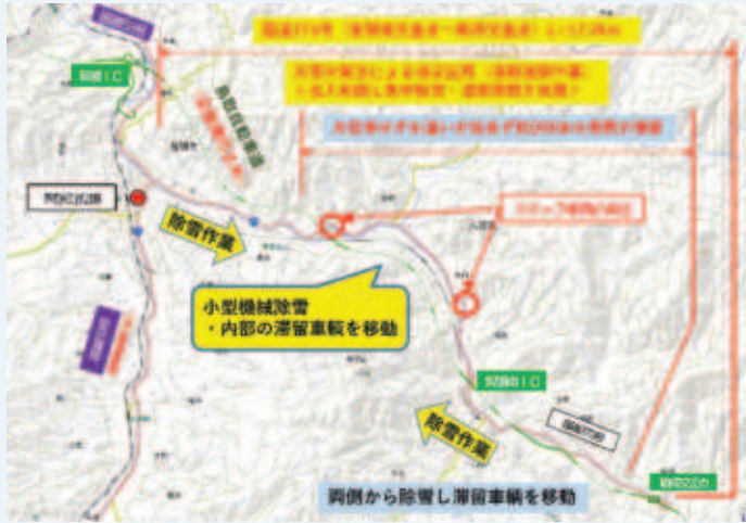
立ち往生車両の解消・道路の復旧に向けた作業状況 (国土地理院の電子地形図に追記を行い作成)
