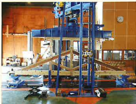
▲県産材を使用したトラス構造の強度試験
