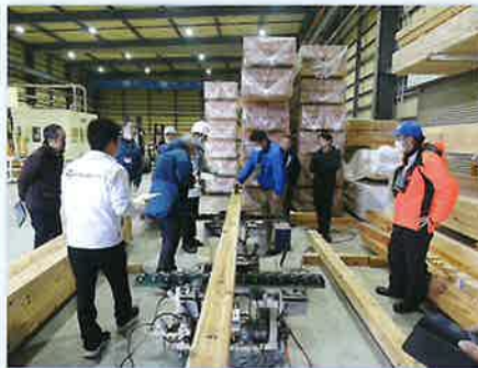
▲木造公共建築物に使用する製材品の含水率試験を支援
