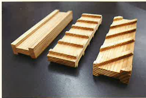
▲製材品の栈木痕を軽減する栈木形状を改良する試み
