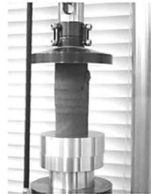
図-2 円柱状の圧縮試験
