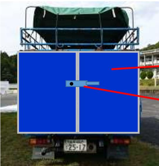
荷台の高さを運転席屋根高までかさ上げ（鉄製）し、観音開きとする。
