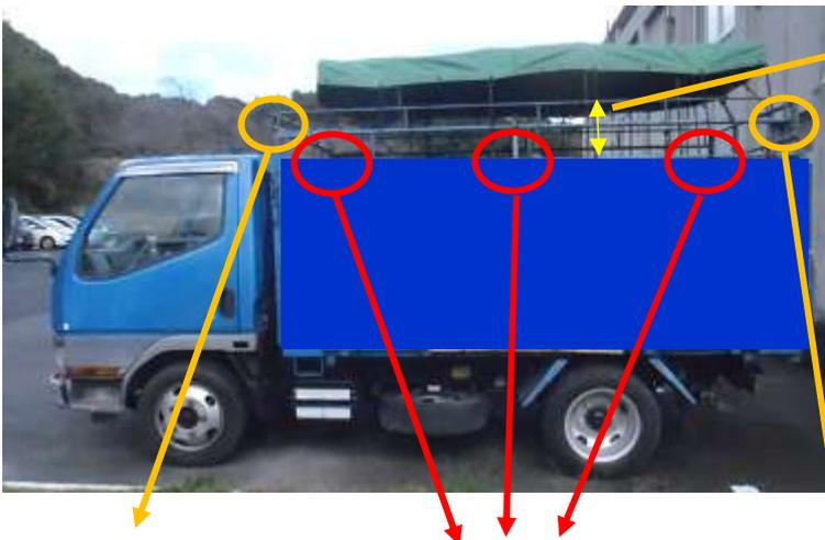
高さ 30cm 程度の柵（鉄製）を設置（取り外し可能）。
