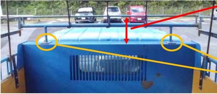
高さ 30cm 程度の柵（鉄製）を設置。（荷台上部にボルトで固定。ボルトを外せば柵の取り外しが可能。）
