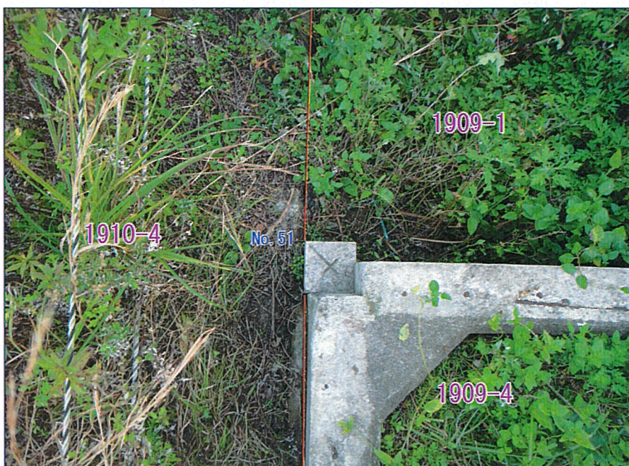
No. 51 標識: 石杭 (既存)
